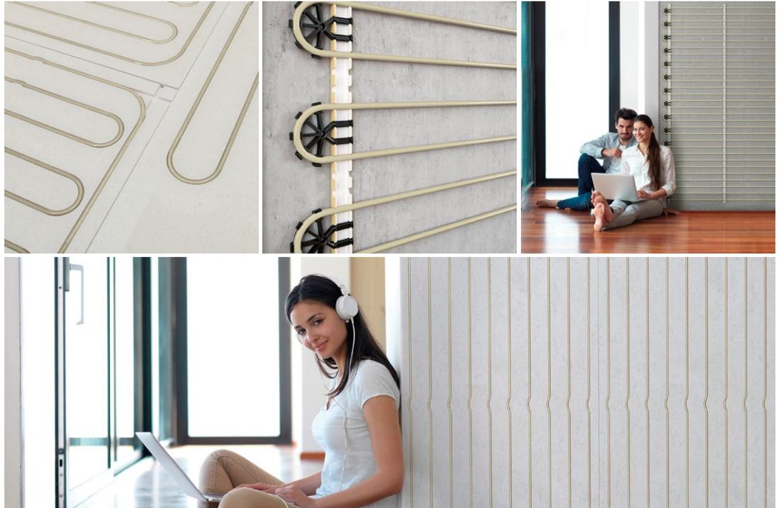
Das System KAN-therm Wandflächentemperierung in der Trockenausführung wird mittels Gipsfaserplatten erstellt. Die Heizrohre sind bereits in den Modulen integriert und werden bauseits mit speziellen Verbindern untereinander im Tichelmann System verbunden. Nach dem Verspachteln der Module können diese mit Tapete oder Wandfarbe versehen werden.
