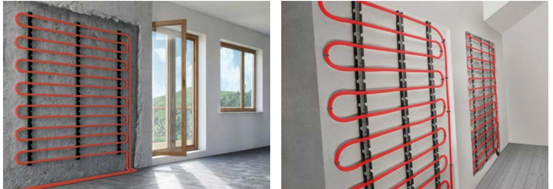
Das System KAN-therm Wand in der Trockenausführung wird mittels Gipsfaserplatten erstellt. Die Heizrohre sind bereits in den Modulen integriert und werden bauseits mit speziellen Verbindern untereinander im Tichelmann System verbunden. Nach dem Verspachteln der Module können diese mit Tapete oder Wandfarbe versehen werden.
