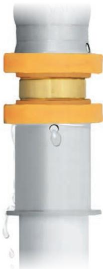
Das Austreten von Wasser während des Füllvorgangs signalisiert eine unverpresste Pressstelle. DVGW „Kontrollierte Leckage“.
