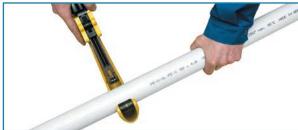
Das Rohr mit dem Rohrschneider senkrecht ablängen.
