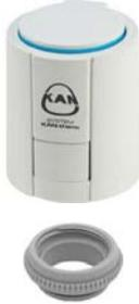
Zur Zonenregelung beim Festwertregelset, Stromlos geschlossen, Steckmontage mit Ventiladapter, Anpassungskontrolle, Funktionsanzeige, inkl. „First-Open“ Funktion, Spritzwasserschutz IP54, „Über Kopf“ Montage möglich, Anschlussleitung 2x 0,75 mm<sup>2</sup>, Länge 1 m, Inkl. Ventiladapter Gewinde M30x1,5.
