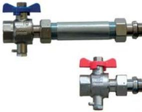
Wärmemengenzähler-Anbauset waagrecht für Festwertregelset. ½" AG, Kugelhahn ¾" IG. Inkl. Fühleranschluss M10x1 im Vor- und Rücklauf. WMZ Kurzschlussstrecke: 110 mm Zur leichten Unterscheidung ist der Rücklauf mit einem blauen Griff ausgerüstet. Für Wärmemengenzähler bis 1,5 m<sup>3</sup>/h.
