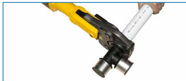
Die Pressbacke auf der Presshülse ansetzen (bündig am Flansch des Formstücks) und verpressen.
