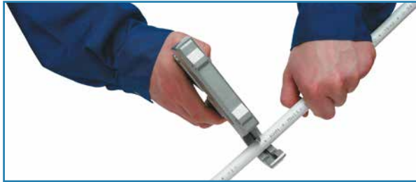
„U“ und „TH“ Das Rohr mit der Rohrschneidezange senkrecht ablängen.
