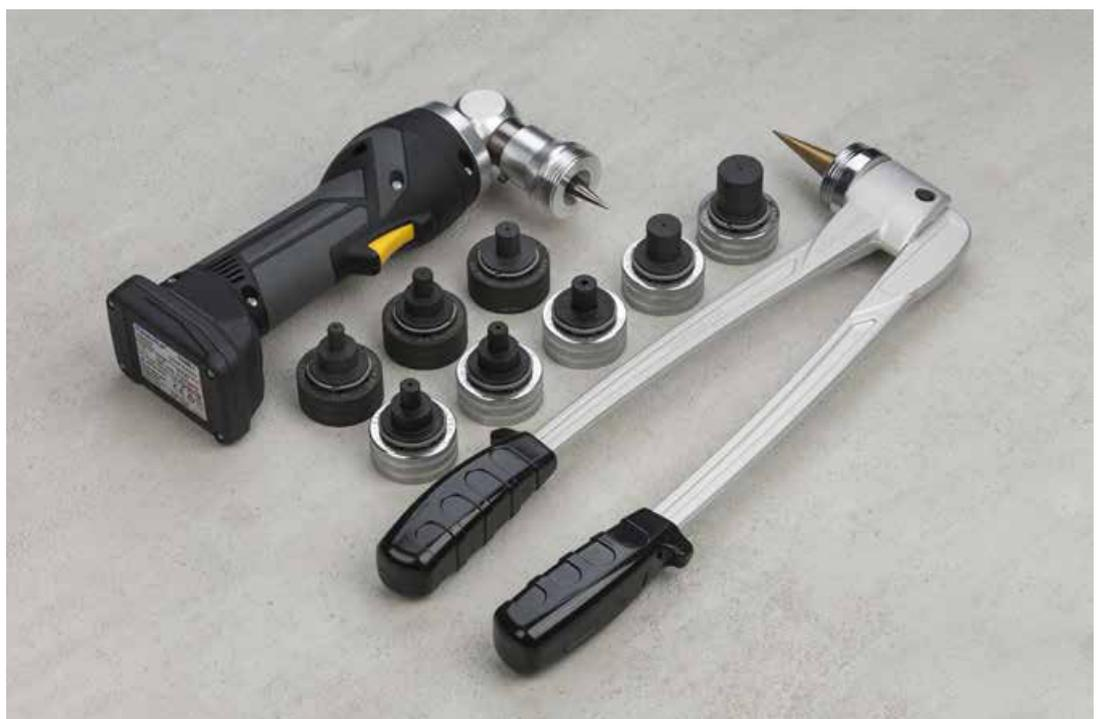
Die **Aufweitköpfe** sind je nach Rohrtyp unterschiedlich ausgeführt. Stellen Sie sicher, dass beim Aufweiten des Rohrendes der richtige Aufweitkopf verwendet wird.
