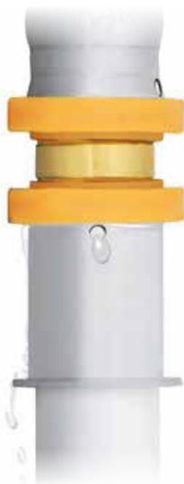
Das Austreten von Wasser während des Füllvorgangs signalisiert eine unverpresste Pressstelle.
