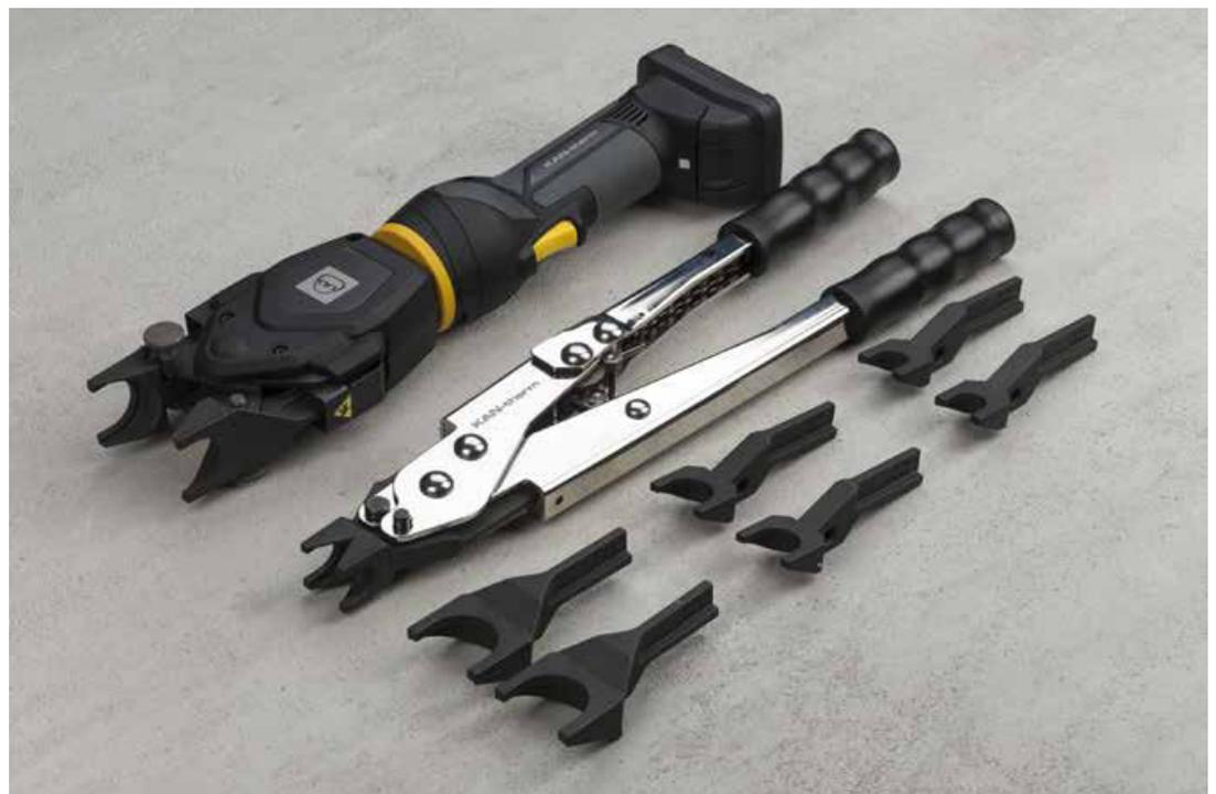
Ein zusätzliches Merkmal des KAN-therm UltraLine-Systems ist die Möglichkeit der Montage unter Verwendung von elektrischen Standardantrieben, die zum radialen Pressen verwendet werden (z. B. das System KAN-therm Press LBP). Diese Option wird mithilfe eines speziellen KAN-therm UltraLine-Systemadapters in Kombination mit einem Presswerkzeug implementiert.
