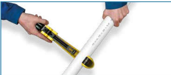
Das Rohr mit dem Rohrschneider senkrecht ablängen.
