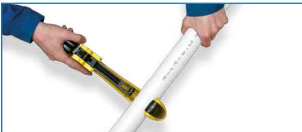
Das Rohr mit dem Rohrschneider senkrecht ablängen.
