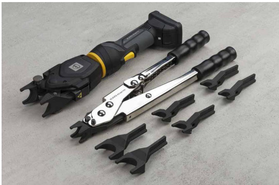
Ein zusätzliches Merkmal des KAN-therm UltraLine-Systems ist die Möglichkeit der Montage unter Verwendung von elektrischen Standardantrieben, die zum radialen Pressen verwendet werden (z. B. das System KAN-therm Press LBP). Diese Option wird mithilfe eines speziellen KAN-therm UltraLine-Systemadapters in Kombination mit einem Presswerkzeug implementiert.
