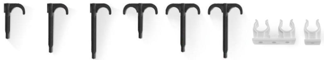
Die Metallgriffe (verzinkter Stahl) sind mit einem flexiblen Einsatz ausgestattet, der Vibrationen und Geräusche dämpft. Sie können als Gleitpunkte (PP) und Festpunkte (PS) für alle oberflächenmontierten KAN-therm-Installationen fungieren. Metallschellen ohne Einsätze können die Oberfläche von KAN-therm-Kunststoffrohren beschädigen und sollten daher nicht verwendet werden.
