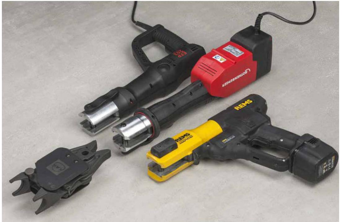
Die Konstruktion der KAN-therm UltraLine System-Klemmgabeln gewährleistet einen sehr weiten Zugangswinkel zum Formstück, was den Montagekomfort an schwer zugänglichen Stellen deutlich erhöht.
