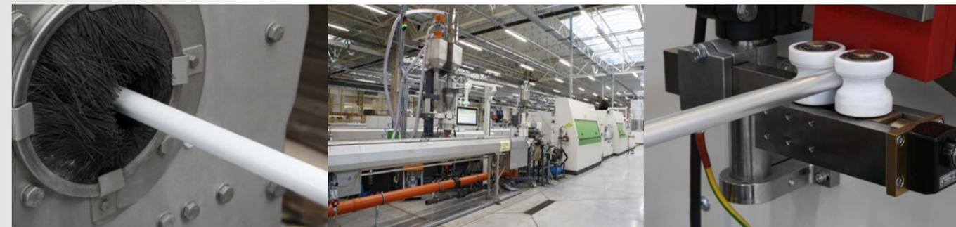
Die in PERTAL<sup>2</sup>-Rohren des UltraLine-Systems vorhandene Schicht aus einer speziellen Aluminiumlegierung ermöglicht es, den Prozess des Aufweitens während der Montage durchzuführen. Darüber hinaus gewährleistet es die Diffusionsdichtigkeit und reduziert die thermische Dehnung um mehr als das 8-fache im Vergleich zu homogenen Rohren.
