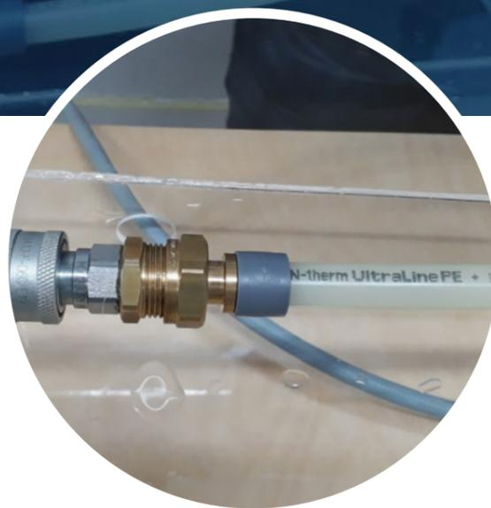
**Beispielprüfung: mit Flüssigkeit gefüllte Rohrproben werden mit steigendem Druck beaufschlagt, bis sie bersten. Nach 15 Tests erhält man die durchschnittlichen Ergebnisse.**
