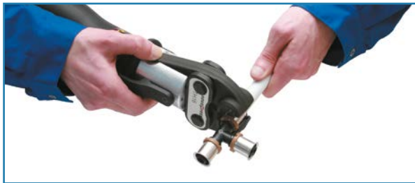
„U“ Die Pressbacke an dem Farbring ansetzen... „TH“ Die Pressbacke mit der äußeren Profilvertiefung über dem Farbring ansetzen...
