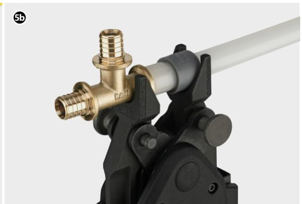
5a. Rüsten Sie die Presse mit speziellen Spanngabeln aus. Für jeden Durchmesser ist ein separater Satz Gabelköpfe vorgesehen. Die Gabelköpfe sind mit speziellen Anschlägen ausgestattet, um das Formstück und die Hülse vor Beschädigungen zu schützen.
