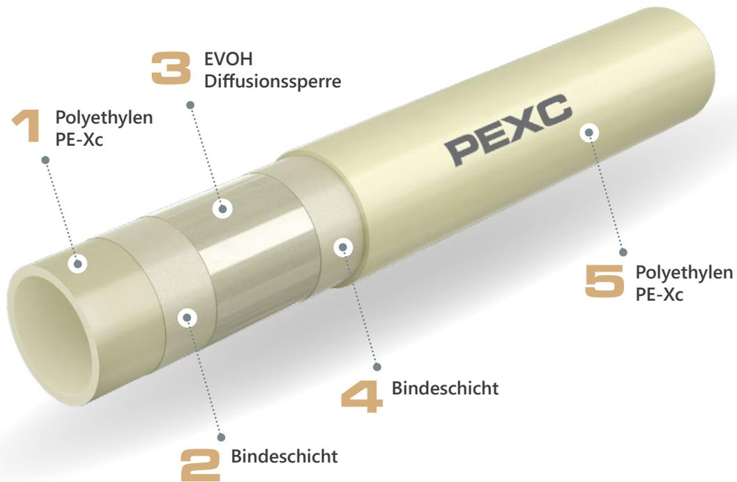
Schemadarstellung der PEXC-Rohre mit EVOH-Diffusionssperre
