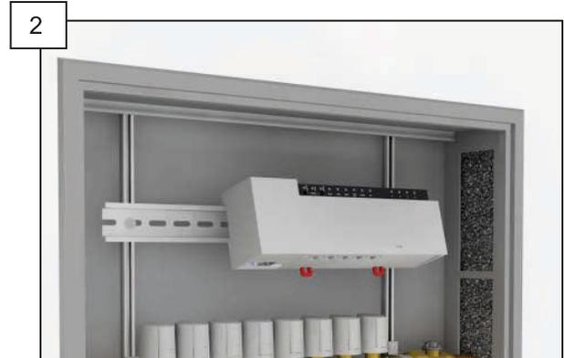
Regelmoduleiste leicht gekippt auf die Hutschiene aufsetzen und einrasten lassen.
