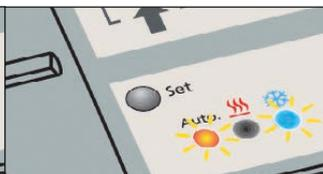
Ist der externe Schaltkontakt aktiv leuchtet der blaue EISKRI-STALL auf den Reglern und am HK-Modul. Das Signal KÜHLEN wird an die Regler übertragen.
