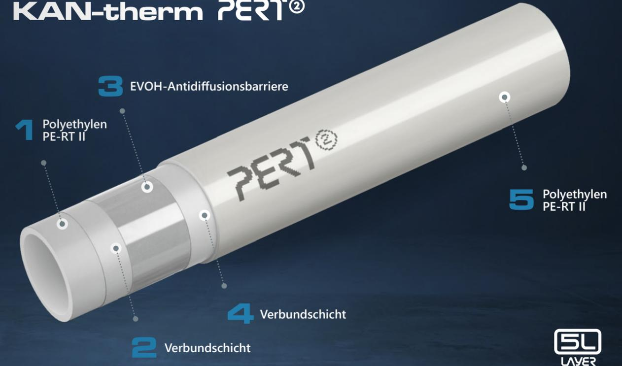
Die PERT<sup>2</sup> und blueFLOOR PERT-Rohre haben durch die 5L-Technologie eine EVOH-Antidiffusionsbarriere, die im Inneren der Rohrwandkonstruktion „verborgen“ ist.
