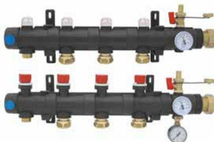
Der KAN-therm Industrierverteiler ist ein modulares Baukasten-System. Bestehend aus Grundmodul und Erweiterungsmodulen. Es gibt zwei verschiedene Erweiterungsmodule: ein Modul mit Abgang  $\frac{3}{4}$ " Eurokonus für Rohr bis 20x2 ohne Klemmverschraubung und ein Modul mit Abgang für Rohr 25x2,3 bis 25x2,5 inkl. Klemmverschraubung. Zur nachträglichen Bestückung mit einem Stellantrieb möglich.
