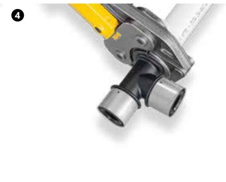
Die Pressbacke auf der Presshülse ansetzen (bündig am Flansch des Formstücks) und verpressen.
