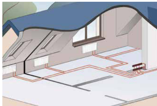
Verteiler- und T-Stück System in der Heizanlage
